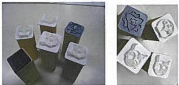
50×50×160mm の大きさを決めて型を 3D プリンタで作り、生乾きの状態で、20mm の厚さに切断した後、押し型タイプの型で、押し印を行いました。
