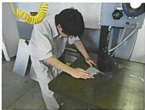
内側製作図 ボール盤で穴をあけて切り取る。
