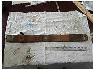
②材料を炉で熱し、ハンマーで叩いて変形させる
