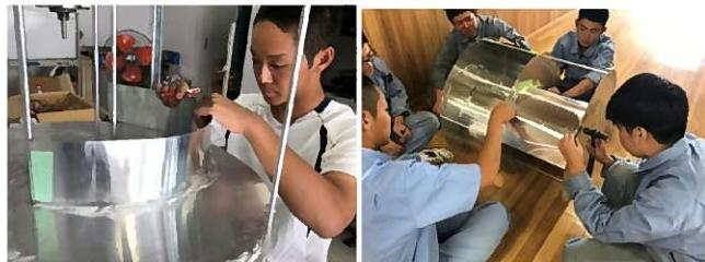
厚さ0.5mmのアルミ板を丸めて、支柱と円盤に固定し、羽根を作った。円盤には、円弧状の溝を切って、アルミ板をはめ込み、反対側で折り曲げた。羽根の隙間をテープで塞ぎ、空気が漏れないようにした。
