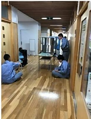
10月24日に垂直軸風車が完成した。風車の発電特性を調べるために、送風機を使って実験を行った。
