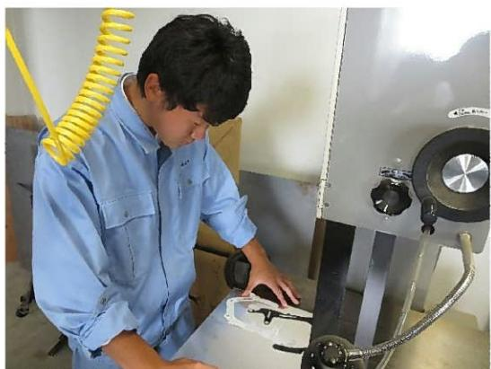
内側製作→ボール盤で穴をあけて切り取る。
