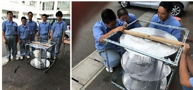
ローターを支える支柱を木製にしたのは、上下発電機のアース端子を絶縁するためである。
