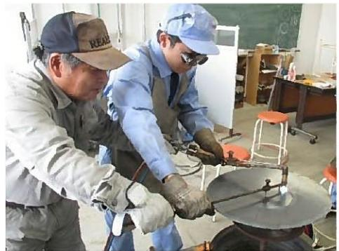
●キャタピラのゴムがかかる部分の帯状の板をシャーリングやプラズマ切断機で直線になるように切断しグラインダーでバリを取る。
