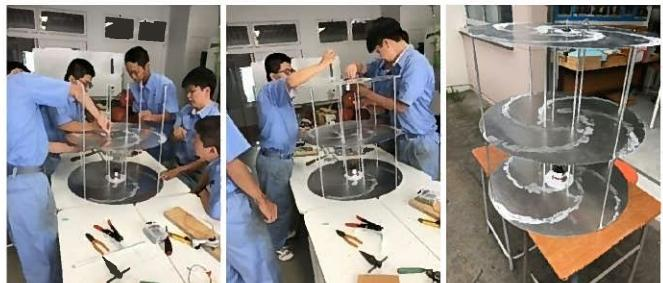
支柱の長さが345mmで正確だと、ローターはぶれずに真っ直ぐ仕上がる。発電機は、羽根の面積を多く取るため、上下内側に固定した。
