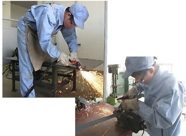
●丸い鉄板に所定の位置にボール盤を使用しΦ14の穴を4カ所にあける
